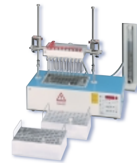
Barkey vapotherm mobil III Zum gleichzeitigen Eindampfen von bis zu 60 Proben For evaporation of up to 60 samples at the same time
